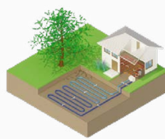
Pompe à chaleur sur capteurs enterrés horizontaux
