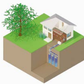
Pompe à chaleur sur corbeilles géothermiques
